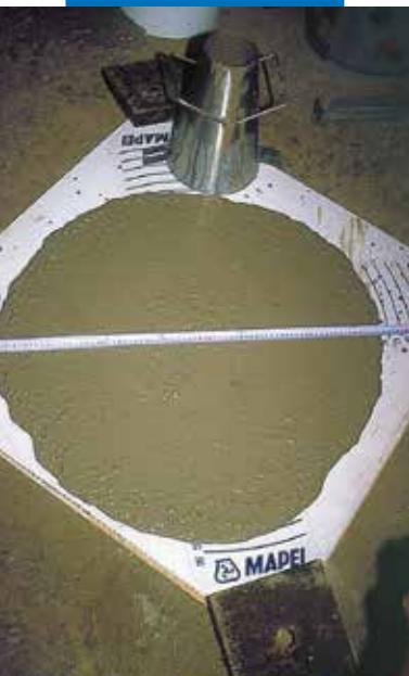
Měření rozlité (slump) na potěru zhotoveném s použitím výrobku Stabilcem SCC
