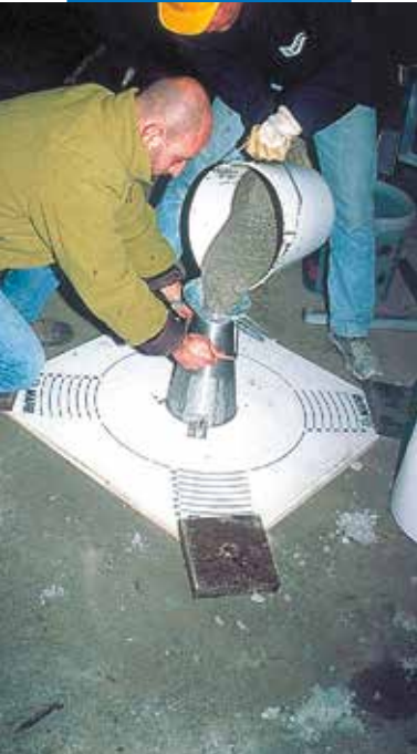
Metoda slump aplikovaná na betonu vyrobeném s použitím výrobku Stabilcem SCC
